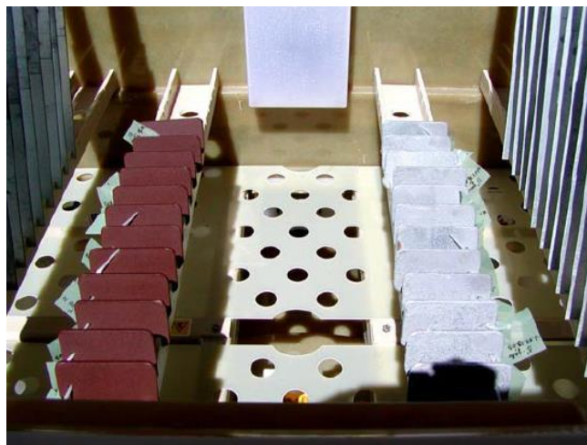
รูปที่ xx ตัวอย่างขนาดและการวางตัวอย่างแผ่นเหล็กในเครื่องทดสอบ CCT
